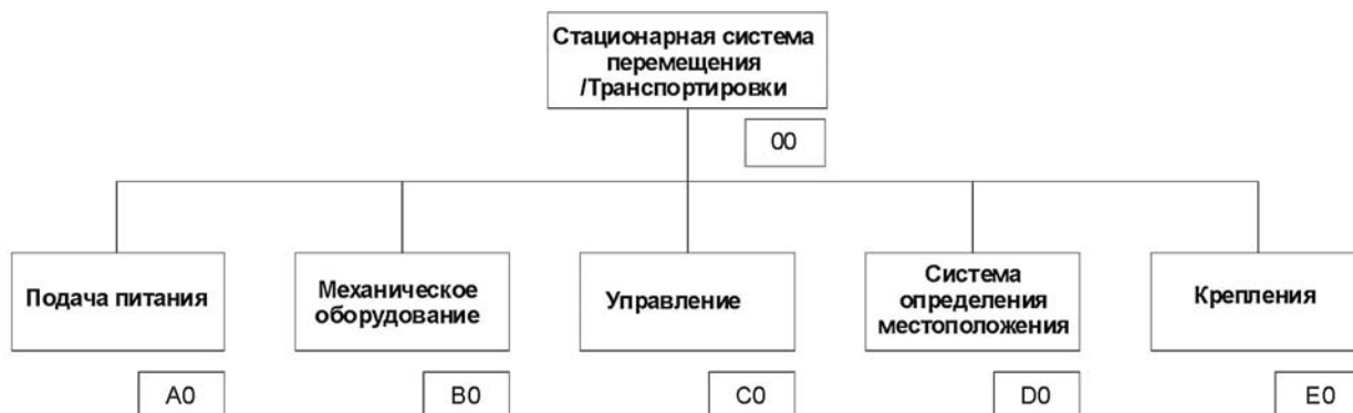
Рисунок 1 Классификация высшего уровня для автоматической подъемно-транспортной системы
